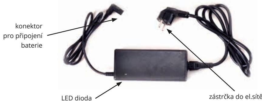
Připojte nabíječku k baterii a až poté k síťovému napětí. Jakmile je nabíječka připojená do el. sítě, rozsvítí se červená LED dioda na nabíječce, která signalizuje zahájení procesu nabíjení. Nabíjení se zastaví automaticky, jakmile je baterie plně nabita. Stav nabití signalizuje zelená LED dioda. Nabíječku nejprve odpojte od el. sítě, následně od baterie. Doba nabíjení baterie na 100% probíhá 5 – 9 hodin (podle stavu vybití). Přerušení procesu nabíjení baterii nepoškozuje.
