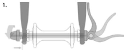
**Brzdy:** provedte kontrolu funkčnosti brzd. Stiskněte obě brzdové páky a tlačte kolo vpřed. Jsou brzdové destičky plně v kontaktu s kotoučem, aniž by se páčky dotýkaly řídítka? Pokud ne je nutné brzdy seřídit (odvzdušnit). Prověřte, zda nejsou brzdové destičky opotřebeny. Brzdové destičky a kotouče se užíváním opotřebují, proto je potřeba brzdy pravidelně servisovat a opotřebené součástky včas vyměnit.
