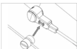
Zkontrolujte jestli je snímací magnet ve správné poloze viz obrázek. Zkontrolujte konektory kabelu displeje. Pokud chyba přetrvá navštívte servisní středisko.
