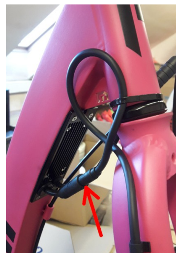
Obr.4: Spojení motorového konektoru a tří- a pěti-pinového konektoru od akcelérátoru a displeje
