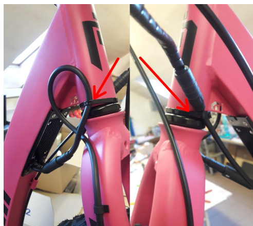
Obr 2: Uchycení kabelů pomocí stahovací násky
