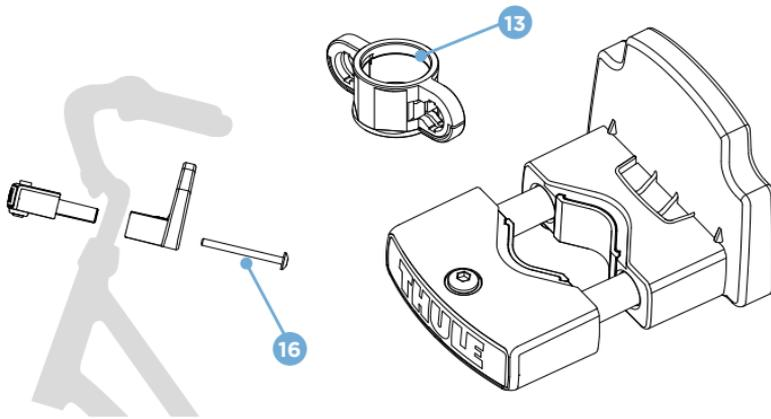
**DE** Zur Montage an einem Fahrrad mit normalem Lenkerschaft nehmen Sie zunächst den Vorbauadapter **13** von der Halterung ab. Setzen Sie den vorderen Teil der Halterung am Lenkerschaft des Fahrrads an. Richten Sie das hintere Ende der Halterung auf das vordere Ende aus und setzen Sie die beiden Schrauben **16** von hinten ein. Ziehen Sie die Schrauben mit dem beiliegenden Inbusschlüssel (Größe 5) abwechselnd mit 8 Nm fest.
