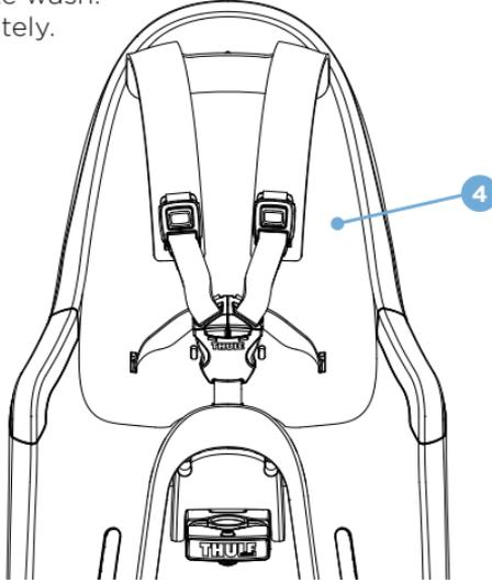
**DE** Der Kindersitz ist mit einer zweifarbig wendbaren und waschbaren Polsterung **4** ausgestattet. Um die Polsterung zu entfernen, nehmen Sie zunächst den Gurt wie in Schritt 10 beschrieben ab. Lösen Sie die Verriegelung an der Rückseite des Sitzes und drücken Sie sie vollständig durch. Um die Polsterung wieder anzubringen, befestigen Sie den Gurt gemäß Schritt 10. Die Polsterung ist maschinenwaschbar bei 30 °C Feinwäsche. Getrennt waschen.
