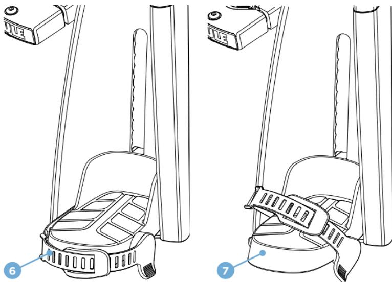
**DE** Die Fußschlaufen **6** können bündig mit der Fußstütze **7** nach unten geklappt werden. Zur Sicherung der Füße werden die Fußschlaufen nach oben über die Füße geklappt und an die Fußgröße angepasst.
