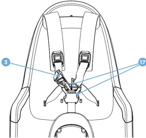
**DE** Zur einfachen Befestigung besitzt der Gurt separate Schlösser **3** für beide Arme, die sich nacheinander befestigen lassen. Sichern Sie den Gurt durch Einstecken des Gurtschlösses, bis Sie ein Klickgeräusch hören. Befestigen Sie unbedingt beide Schlösser. Um den Gurt zu lösen, drücken Sie die seitliche und vordere Taste **17** gleichzeitig und ziehen Sie das Gurtschloss nach oben.
