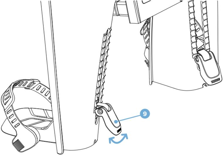
**DE** Passen Sie die Höhe der Fußstütze an, indem Sie den Versteller hinten nach oben schieben **9**. Stellen Sie die gewünschte Höhe ein und drehen Sie den Versteller wieder nach unten, um die Fußstütze zu sichern.
