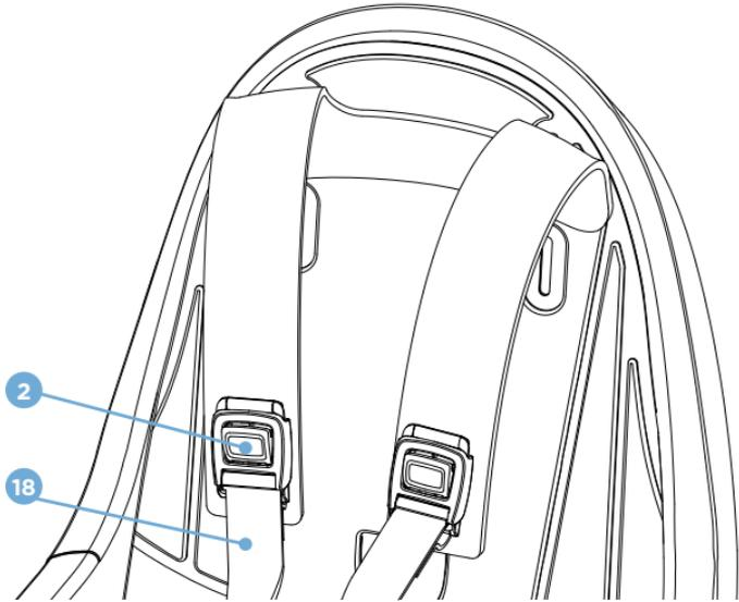
**DE** Die Länge des Gurts kann bequem angepasst werden. Straffen Sie den Gurt, indem Sie die Enden **18** mit einer Hand nach unten ziehen. Um den Gurt zu lockern, drücken Sie den blauen Gurtversteller **2** und ziehen Sie den Gurt nach oben.
