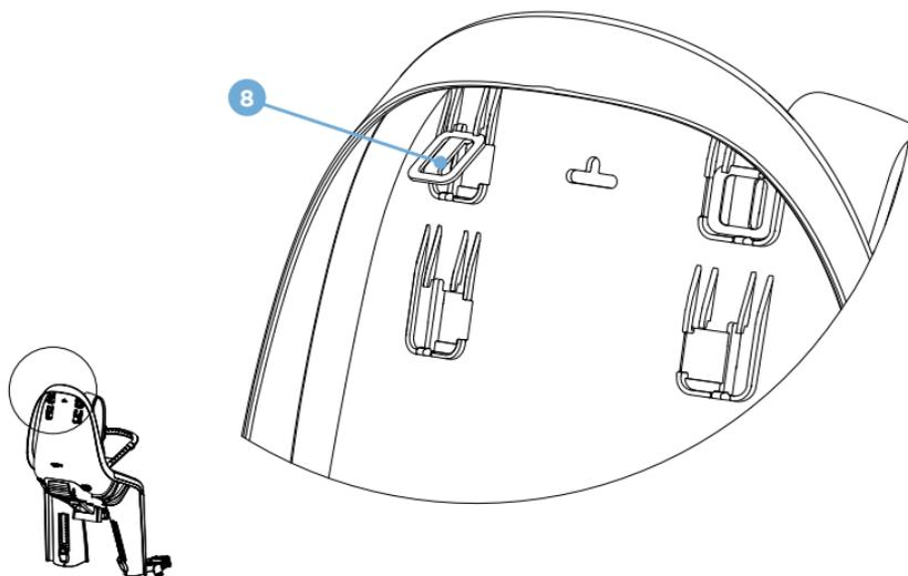
**DE** Sie können den Gurt abnehmen, indem Sie das Steckschloss **8** von hinten und von der Unterseite des Sitzes vollständig durchdrücken. Lösen Sie das Gurtschloss, um den Gurt vom Sitz zu trennen. Um den Gurt wieder zu befestigen, setzen Sie das Steckschloss von vorne ein und sichern Sie es an der Rückenlehne sowie an der Unterseite des Sitzes, bis es einrastet.
