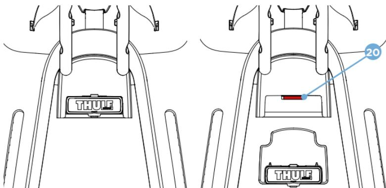
**DE** Positionieren Sie den Kindersitz richtig über der Halterung. Setzen Sie den Kindersitz auf der Halterung nach unten ab, bis Sie ein Klickgeräusch hören. Wenn die rote Warnanzeige **20** nicht mehr sichtbar ist, ist der Kindersitz ordnungsgemäß auf der Halterung montiert.
