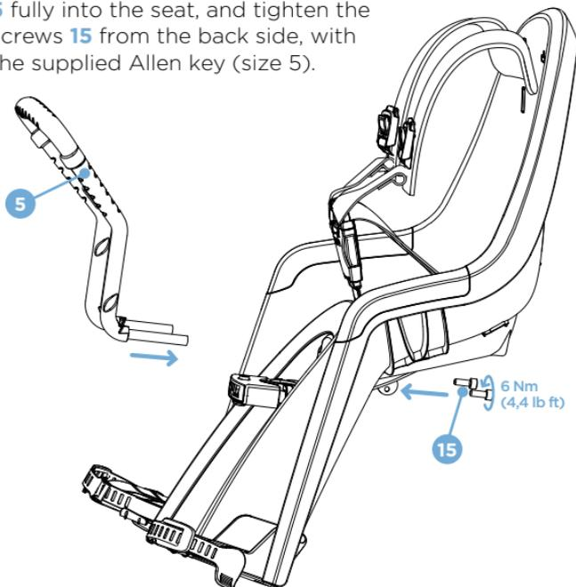
**DE** Bauen Sie den Kinderlenker von der Transporthalterung ab. Die Transporthalterung ist aus recyclingfähigem Kunststoff gefertigt und kann zum erneuten Gebrauch verwahrt werden. Setzen Sie den Kinderlenker **5** vollständig in den Sitz ein und ziehen Sie die Schrauben **15** mit dem beiliegenden Inbusschlüssel (Größe 5) von hinten fest.
