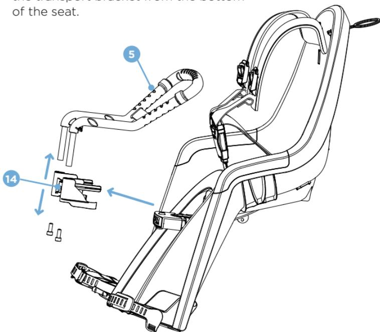
**DE** Der Kindersitz wird mit einer Transporthalterung geliefert **14**, an der sich der Kinderlenker **5**, Schlüssel und der im Lieferumfang enthaltene Inbusschlüssel befinden. Bauen Sie die Transporthalterung vom unteren Teil des Sitzes ab.
