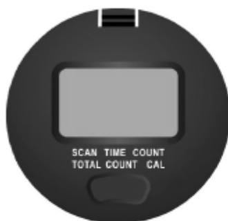
**Ovládání:** Stiskněte na 3 sekundy tlačítko pod LCD displejem a veškeré naměřené hodnoty budou vymazány. Trojúhelníky ukazují, které funkce jsou aktivní. Počítadlo se automaticky vypne po neaktivitě delší než 4 minuty.
