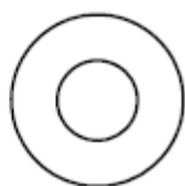
Č. 113: PLOCHÁ PODLOŽKA M8 X \Phi 18 12x
