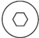
Č. 11: IMBUSOVÝ ŠROUB M8 X 10L – ÚPLNÝ ZÁVIT 5x
