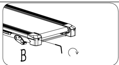
Běžecký pás se průběhem času uvolní. Abyste ho znova utáhli, pootočte oběma stavěcimi šrouby o celou otáčku. Zkontrolujte utažení pásu. Tento postup opakujte, dokud nebude pás rádně utažený. Dávejte si pozor, abyste oba šrouby utáhli stejnou mírou. Řídte se dle obrázku C.
