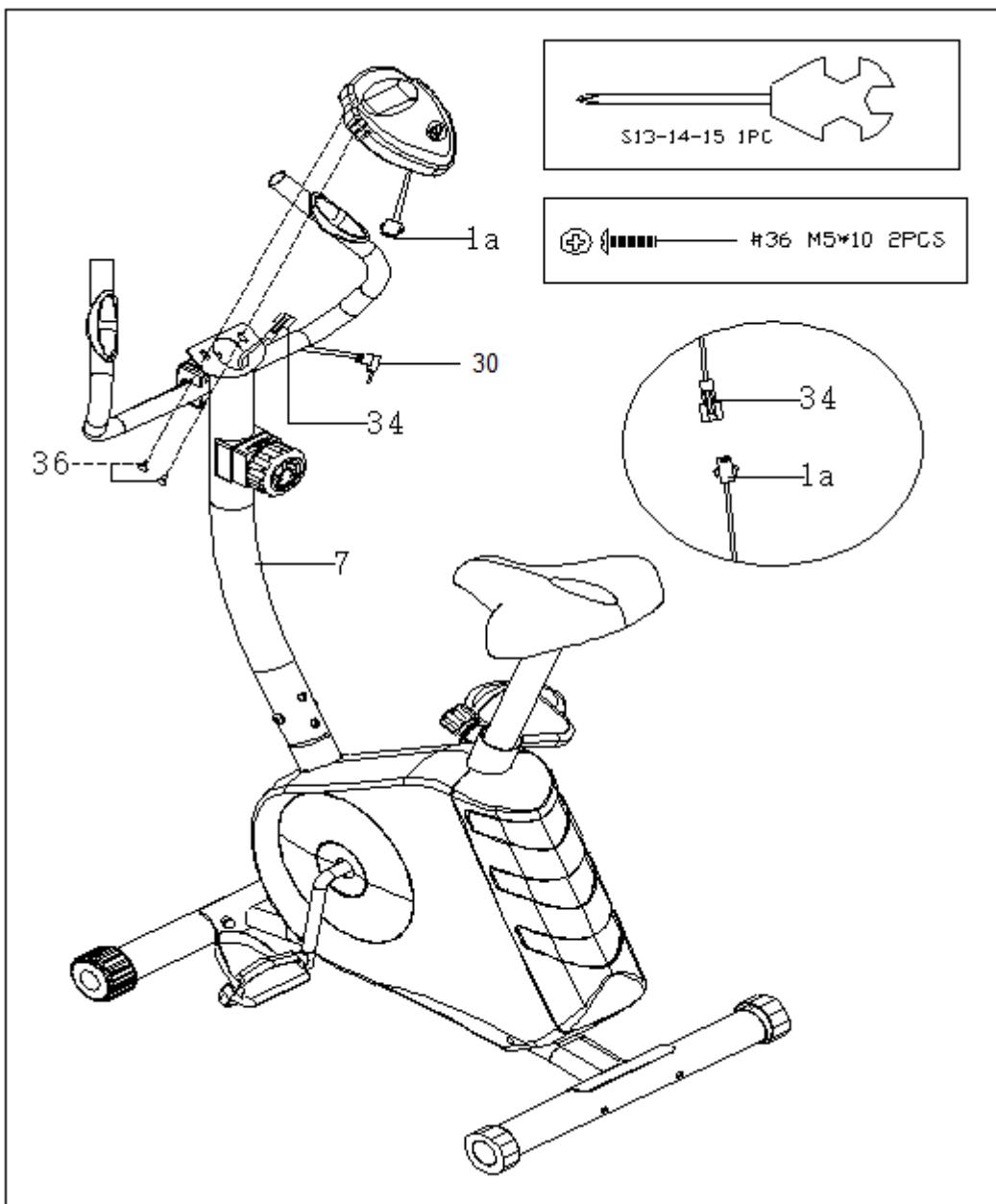
Propojte počítačový kabel (1a) s kabelem induktoru (34). Připevněte počítač (1) k přednímu sloupu (7) pomocí křížových šroubů (36). Zapojte kabel snímače tepu (30) do zdířky na zadní straně počítače (1).
