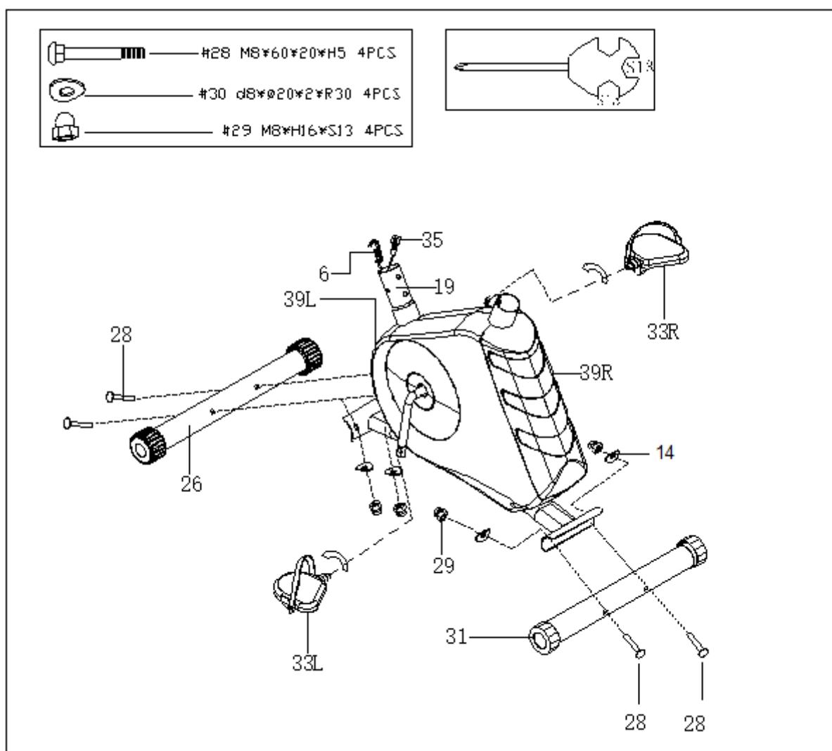
Připevněte přední nosník (26) a zadní nosník (31) k hlavnímu rámu (19) pomocí vratových šroubů (28), prohnutých podložek (14) a kloboučkových matic (29).
