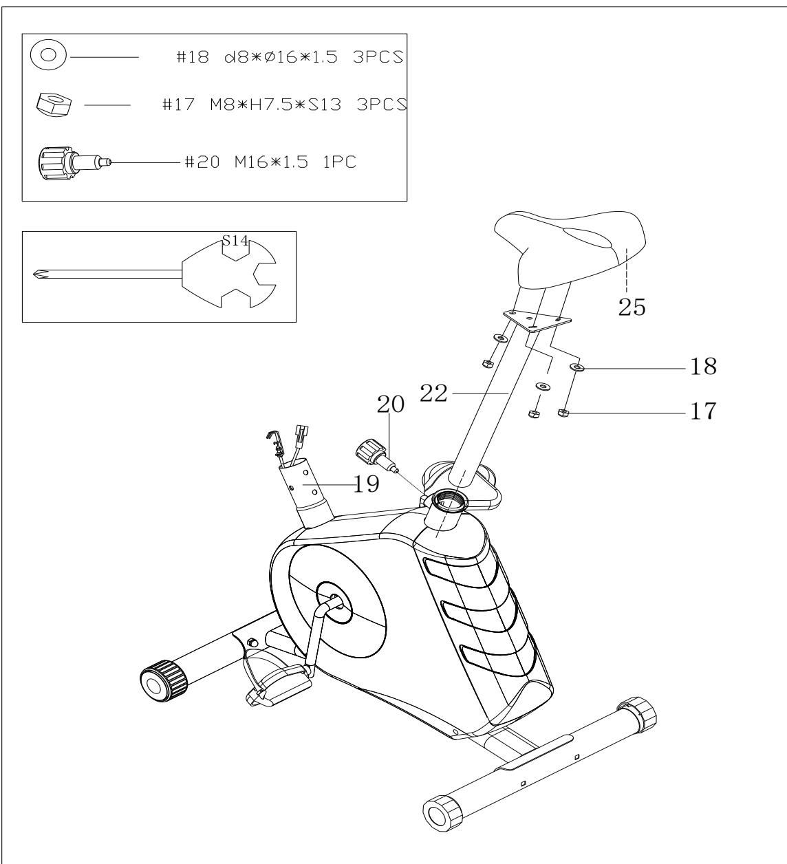
Připevněte sedlo (25) k sedlovce (22) pomocí podložek (18) a samojistících matic (17).
