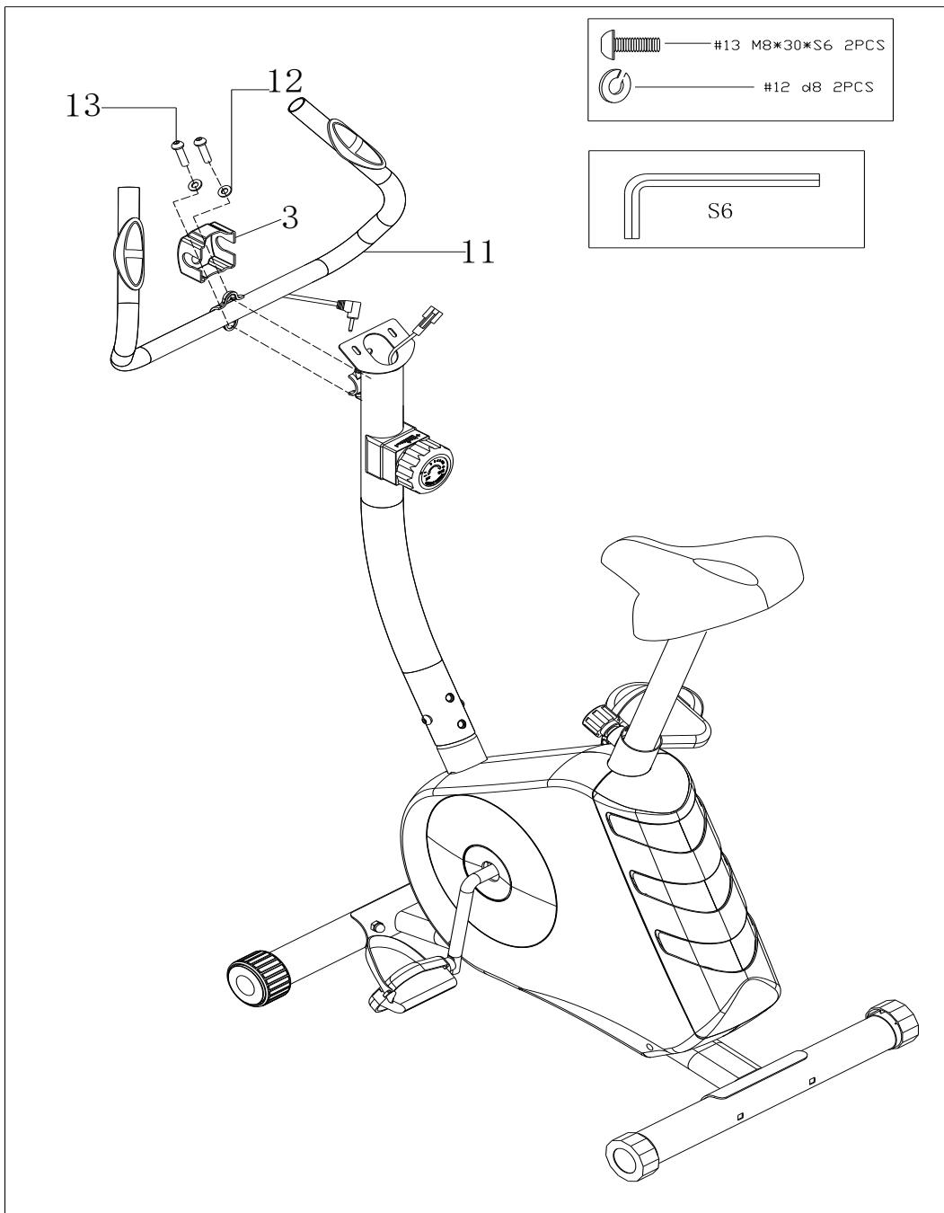
Připevněte řídítka (11) k přednímu sloupu pomocí imbusových šroubů (13) a pérových podložek (12). Nasadte na řídítka přední krytku (3).
