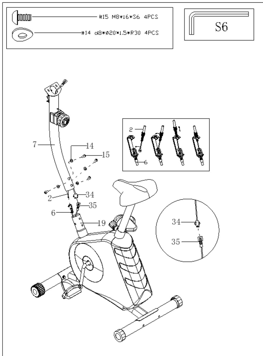
Propojte kabel snímače rychlosti (35) s propojovacím kabelem (34).
