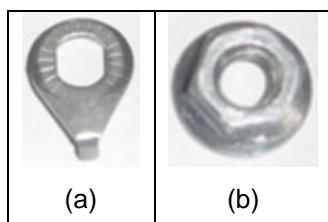
Pojistné podložky (a) se umisťují z vnější strany vidlice, mezi vidlici a matici (b). Po vycentrování kol utáhněte matice (b) nadoraz pomocí šestihranného klíče.
