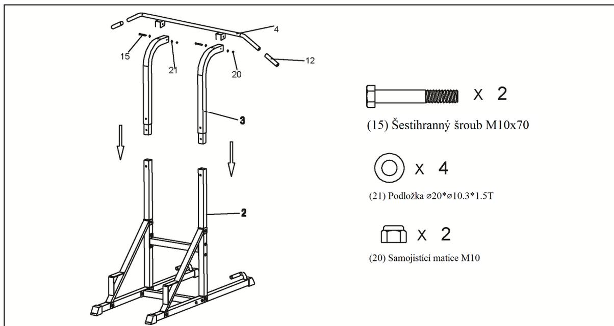
Připevněte hrazdu (4) k horním sloupkům (3) pomocí šestihranných šroubů M10\*70 (15), podložek  $\varnothing 20 \times \varnothing 10.3 \times 1.5T$  (21) a samojistících matic M10 (20), poté vsuňte horní sloupky (3) do spodních sloupků (2) (viz obrázek).
