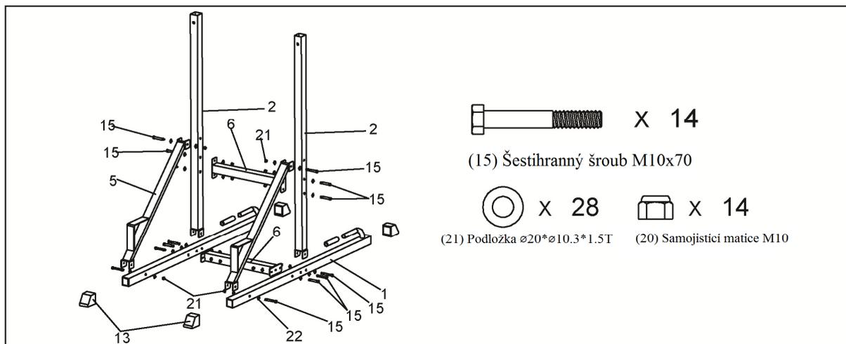
Upevněte spojovací tyč (6) k levé a pravé základně (1) pomocí šestihranných šroubů M10\*70 (15), podložek  $\varnothing 20 \times \varnothing 10.3 \times 1.5T$  (21) a samojistících matic M10 (20).
