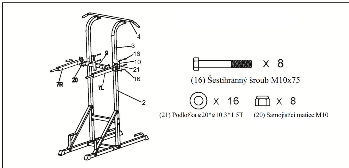
Připevněte k levému spodnímu a hornímu sloupku (2 a 3) levé bradlo (7L) pomocí montážní destičky (10), šestihranných šroubů M10\*75 (16), podložek  $\varnothing 20 \times \varnothing 10.3 \times 1.5T$  (21) a samojistících matic M10 (20) (viz obrázek). Poté upevněte stejným způsobem pravé bradlo (7R).
