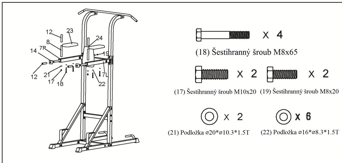
Připevněte k levému a pravému bradlu (7L a 7R) jednoruční madla (8) pomocí šestihranných šroubů M10\*20 (17) a podložek  $\varnothing 20 \times \varnothing 10.3 \times 1.5T$  (21).
