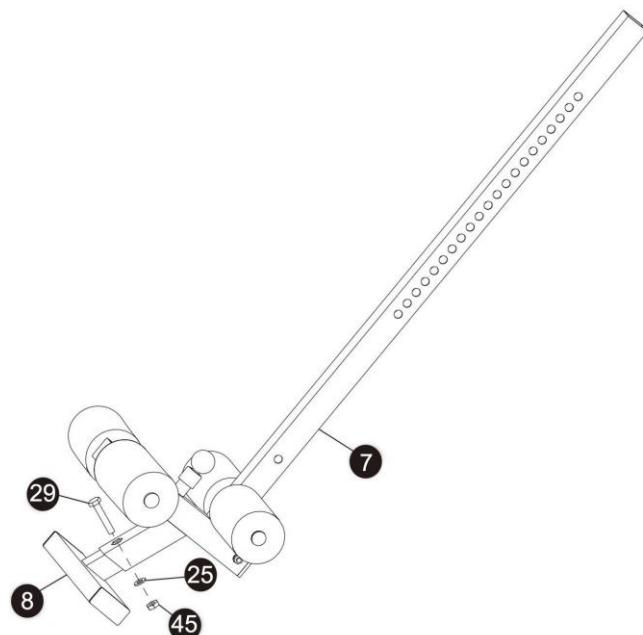
Nasuňte opěrku nohou (8) do nastavitelného rámu (7) a zajistěte pomocí 1x šroubu M8x45 (29), 1x ploché podložky M8 (25) a 1x matice M8 (45).
