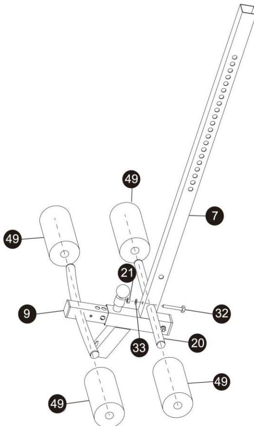
Do rámu (7) nasuňte osu pěnových válců (20) a zajistěte pomocí 1x šroubu M6x42 (32), 1x ploché podložky M6 (33), 1x matice (21).
