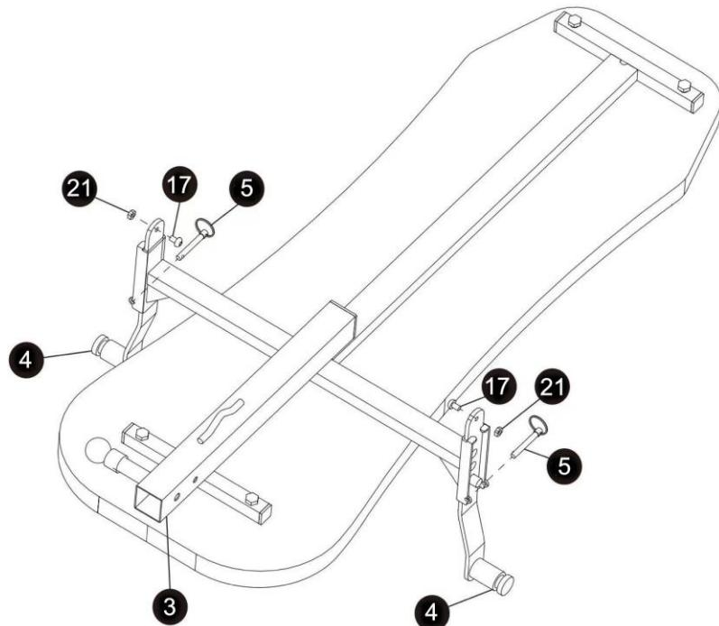
Připevněte 2x ramena (4) a rám opěrky zad (2). Ujistěte se, že jsou ramena správně zasunuty v rámu. Pomocí 2x šroubů M6x10 (17) a 2x matic M6 (21) ramena a poté zajistěte pomocí 2x pojistných pinů 6xL43 (5). Tím zabráníte náhodnému vysunutí ramena.
