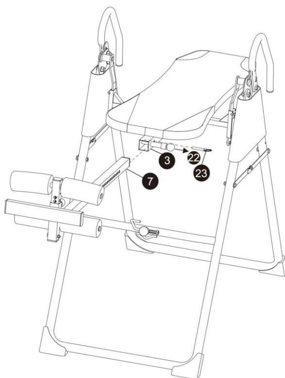
Nasuňte rám (7) do rámu (3). Zajistěte pomocí pinu (23) a pinu s pružinou (22). Ujistěte se, že jsou všechny rámy bezpečně zajištěny.
