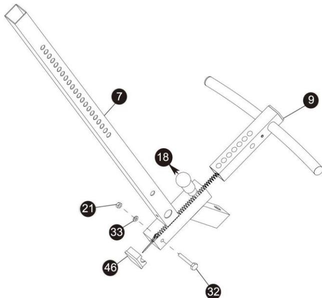
Nasuňte nastavitelnou opěrku nohou (9) do nastavitelného rámu (7). Do rámu (9) nasuňte nastavitelný pin (18) a poté zajistěte pružinu na spodní stranu rámu (7) pomocí 1x šroubu M6x42 (32), 1x podložky M6 (33) a 1x matice M6 (21).
