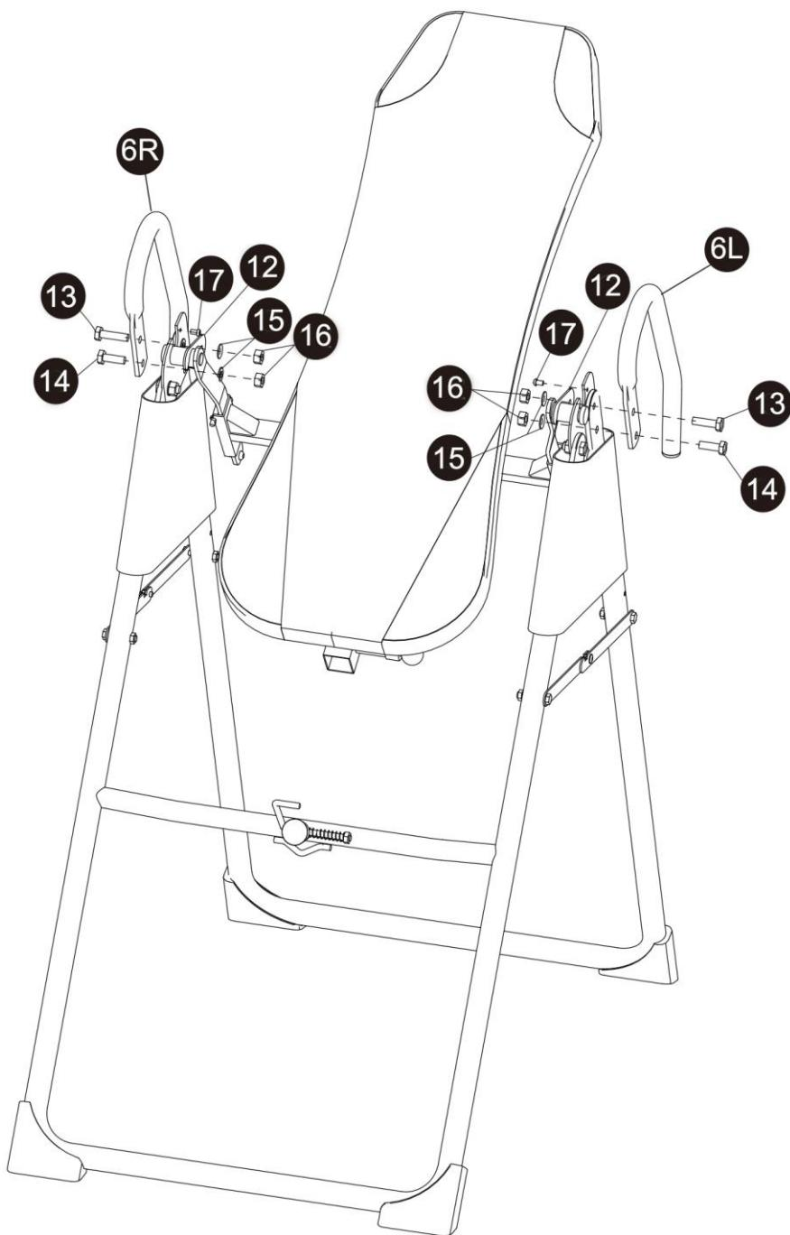
Pomocí 1x šroubu M10x35 (13) a 1x šroubu M10x30 (14) připevněte levé madlo (6L) na zadní základnu (2).
