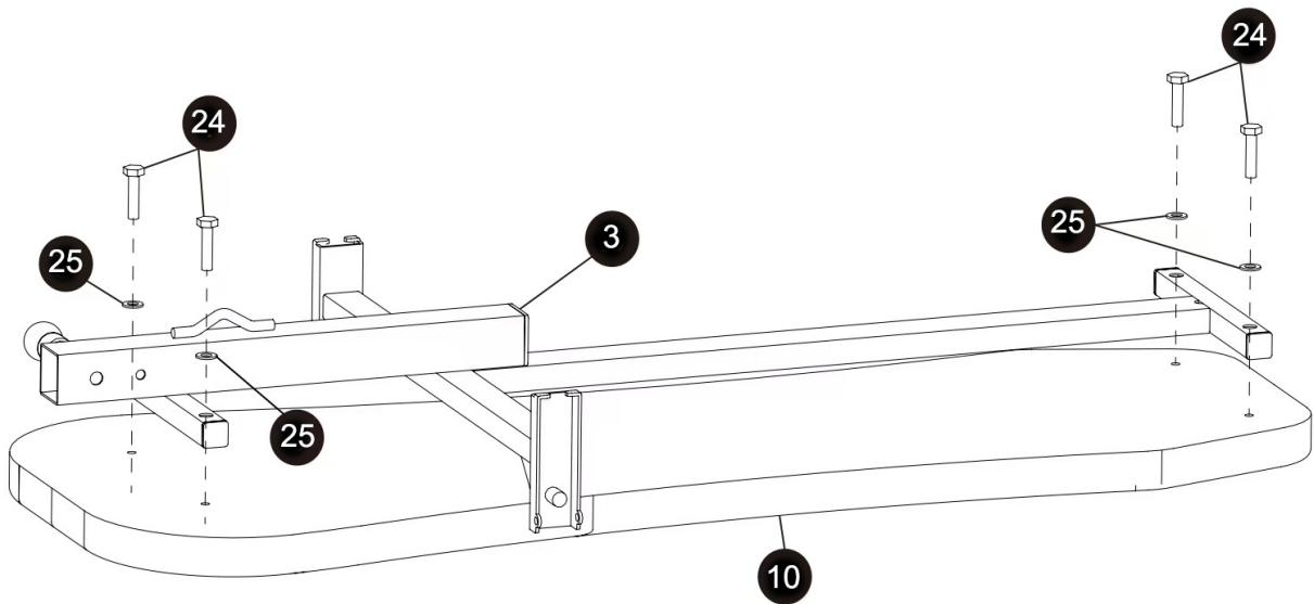
Připevněte opěrku zad (10) na rám (3) pomocí 4x podložek M8 (24) a 4x šroubů M8x35 (25).
