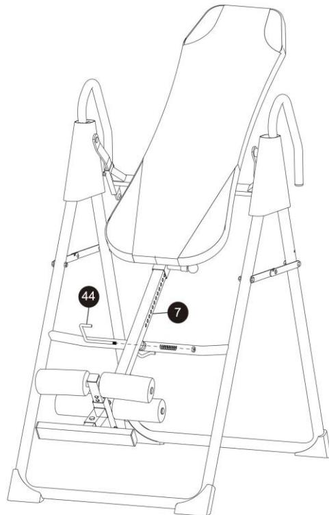
Podle modelu a výrobu je možné, že je potřeba připevnit pojistku (44) do rámu (7) pomocí pružiny (47), 1x podložky M8 a 1x matice M8.
