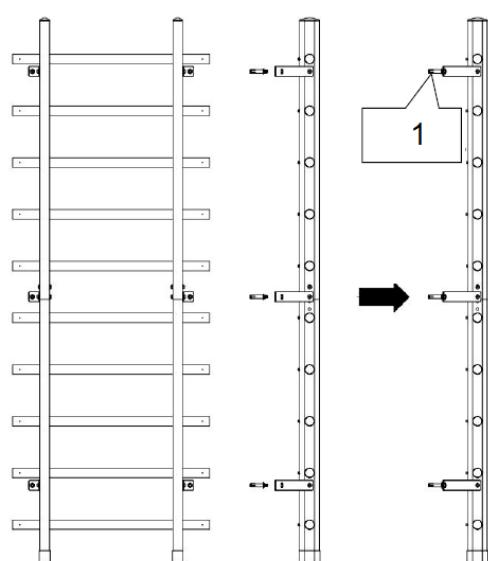
1. Připevněte nosné šrouby M8x80 mm
