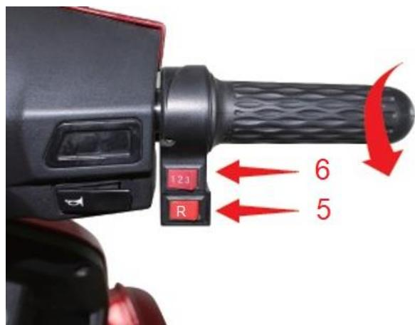
Rychlostní stupeň přepínáte pomocí tlačítka 6, pohyb dopředu nebo couvání pomocí tlačítka 5 (pro couvání tlačítko stiskněte, pro pohyb dopředu jej opět vypněte). Rychlosť ovládáte pomocí plynu na pravé straně
