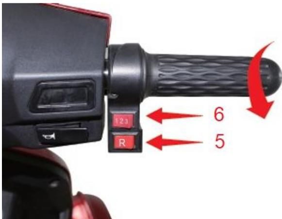
Rychlostní stupeň přepínáte pomocí tlačítka 6, pohyb dopředu nebo couvání pomocí tlačítka 5 (pro couvání tlačítko stiskněte, pro pohyb dopředu jej opět vypněte). Rychlost ovládáte pomocí plynu na pravé straně
