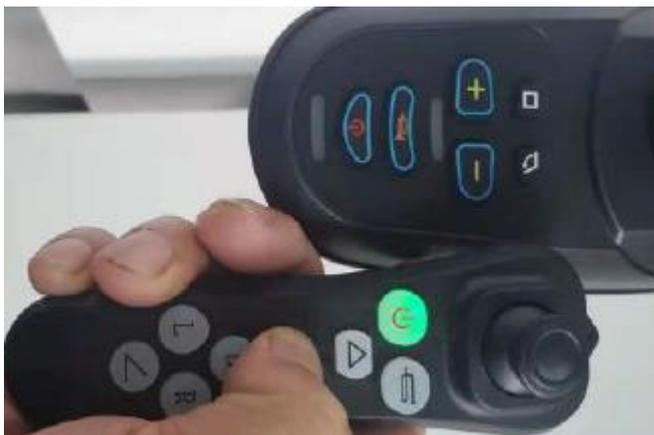
Pro změnu náklonu opěradla stiskněte tlačítko B a poté pomocí šipek upravte náklon.
