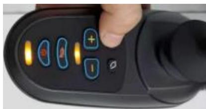
Pomocí joysticku poté můžete měnit náklon dopředu nebo dozadu. Po nastavení náklonu, stiskněte tlačítko pro potvrzení.
