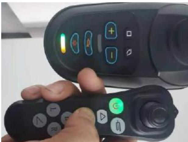
LED dioda na ovladači vozíku se vypne a ovladače jsou spárovány.
