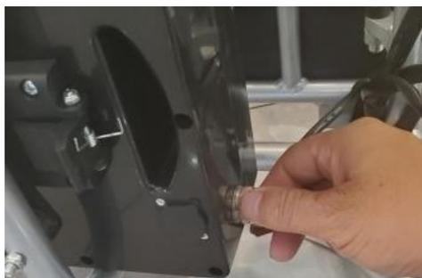
Vytáhněte napájecí kabel
