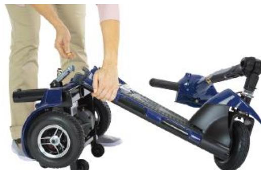
7. Zvedněte část, kde jsou dvě části spojené a uvolněte je z háčků.
