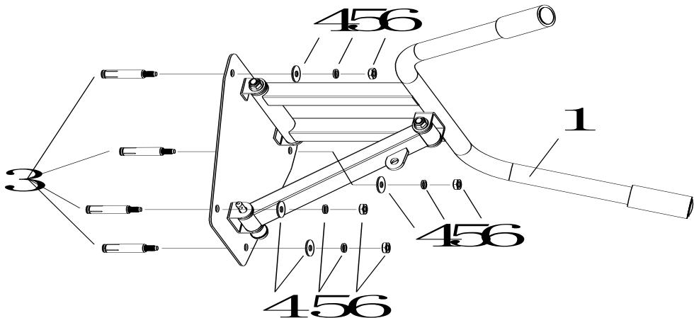
Do stěny vyvrtejte odpovídající otvory. Připevněte bradla pomocí šroubů (3), podložek (4 a 5) a matic (6).
