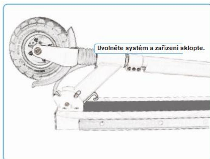
**POZNÁMKA:** Zařízení je vybaveno unikátním sklápěcím systémem, který umožňuje rychlé a snadné sklopení pro optimální přenos, přepravu nebo skladování.
