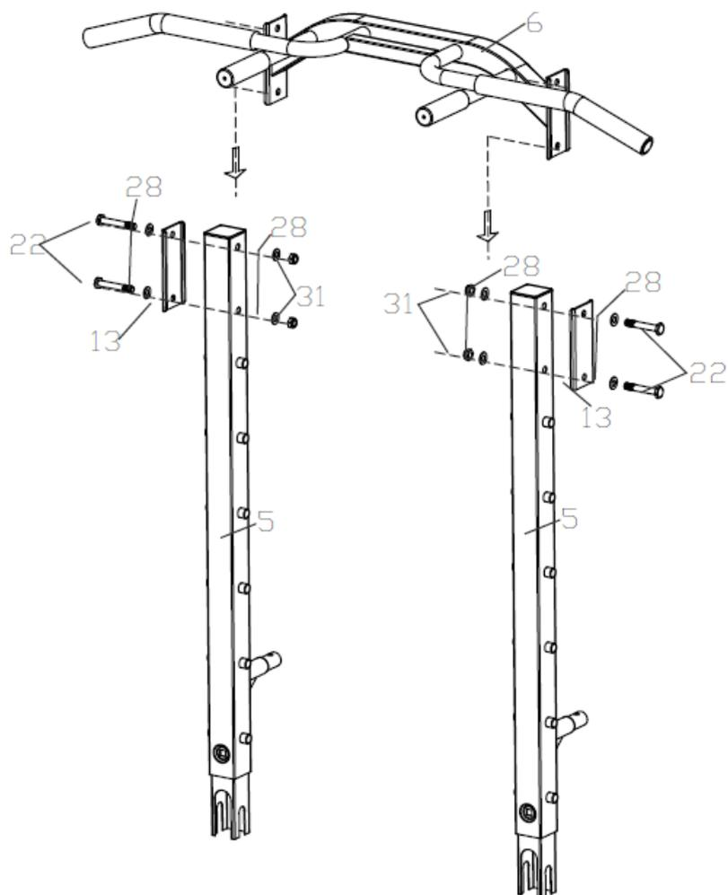
Připevněte rám pro přitahy (6) k ráům (5) pomocí 4x šroubů (22), 8x podložek (28), 4x matic (31) a 2x destiček (13).
