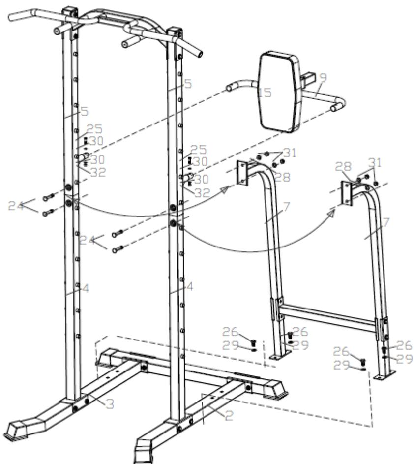
Rámy (4 a 5) spojte pomocí podpůrných rámu (7) pomocí 4x šroubů (24), 4x podložek (28) a 4x matic (31). Podpůrné rámy (7) připevněte do nosníků (2 a 3) pomocí 4x šroubů (26) a 4x podložek (29). Připevněte rám opěrky (9) na rám (5) pomocí 2x šroubů (25), 4x podložek (30) a 2x matic (32).
