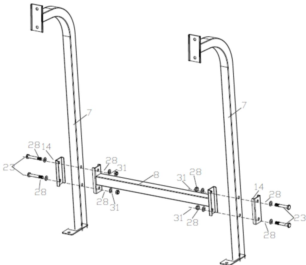
Připevněte spojovací rám (8) k podpůrným ráům (7) pomocí 2x destiček (14), 4x šroubů (23), 8x podložek (28) a 4x matic (31).
