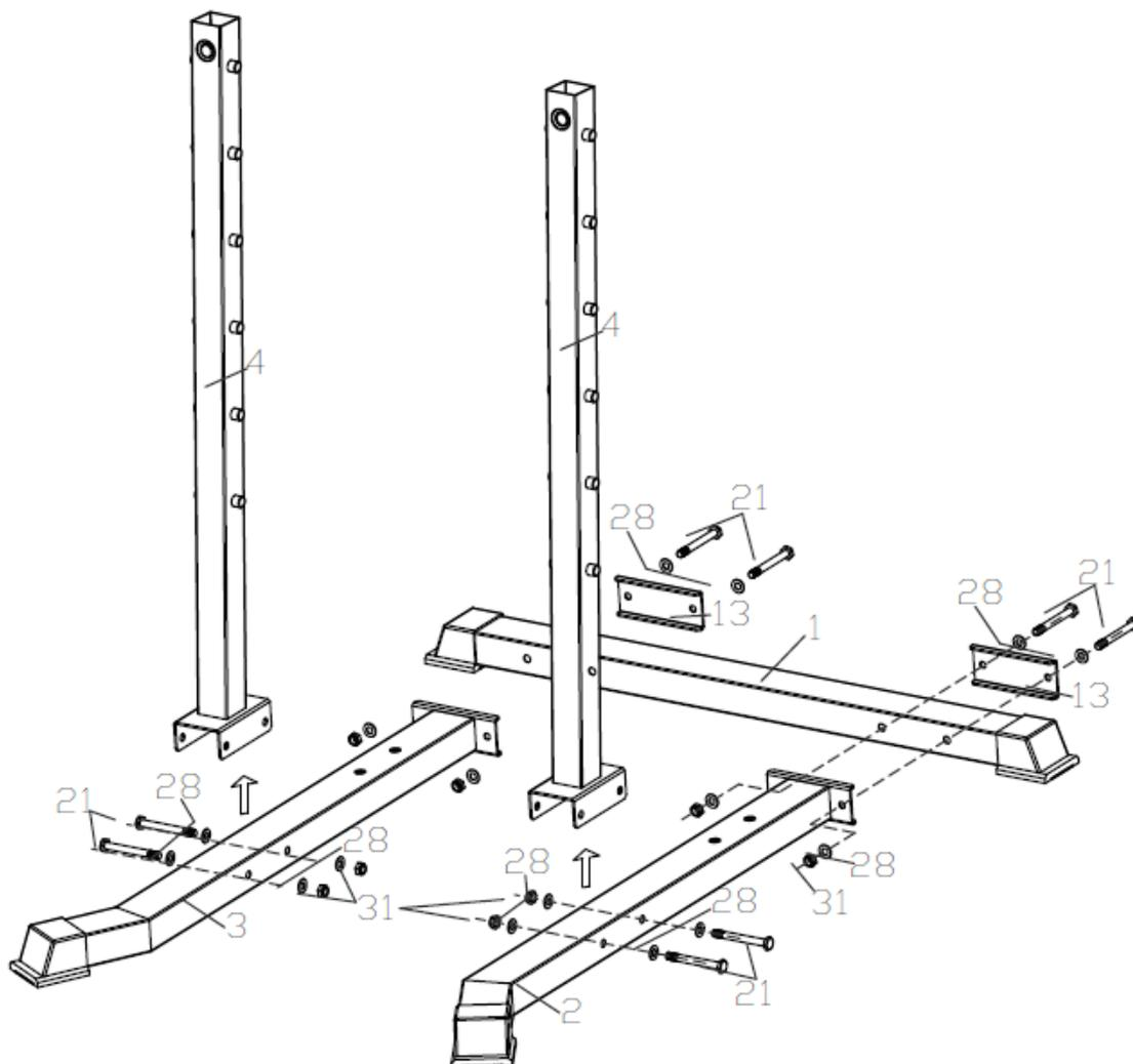
Spojte rámy (2 a 3) k zadnímu rámu (1) pomocí 2x destiček (13), 8x podložek (28), 4x šroubů (21) a 4x matic (31).
