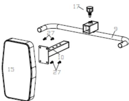
Připevněte držák opěrky (10) do rámu opěrky (9) pomocí ručního šroubu (17). Na držák opěrky připevněte opěrku (15) pomocí 4x šroubů (27).
