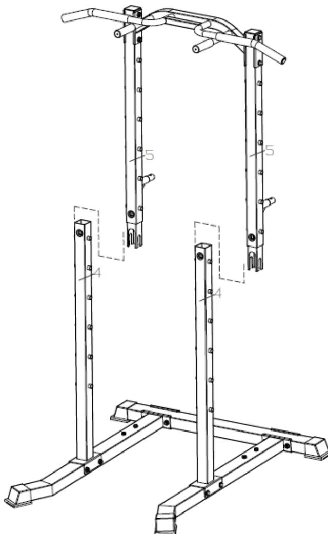
Nasuňte horní konstrukci (5) na spodní konstrukci (4).
