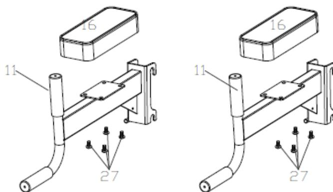
Připevněte 2x opěrky loktů (16) na madla (11) pomocí 8x šroubů (27).
