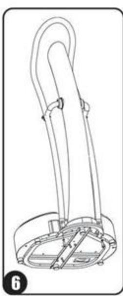
Upevnite rukoväť k podstavcu pomocou 2 skrutiek M10x30 a perových podložiek.
