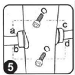
Upevnite rukoväť ku stípiku pomocou 4 skrutiek M6x20 a perových podložiek.
