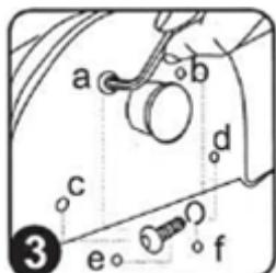
Upevnite ho pomocou 6 skrutiek M8x25 a perových podložiek na spodnú časť stroja.
