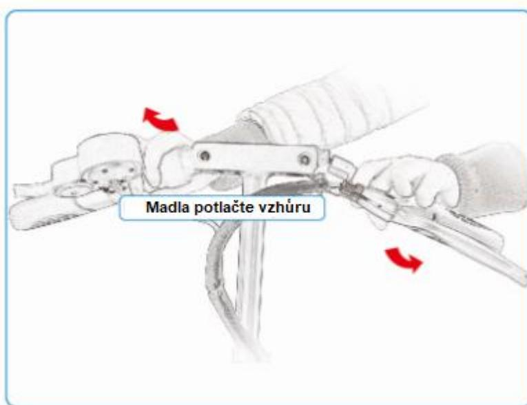
**POZNÁMKA:** Před každým použitím prověrte, zda je pojistka řádně zasunuta do centrálního sklápěcího mechanismu. Jinak riskujete zranění nebo poškození přístroje.
